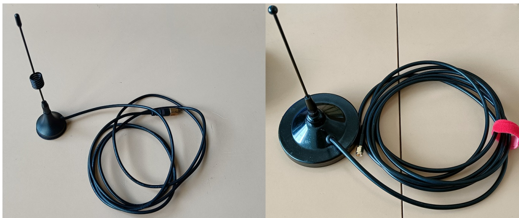
Obrázek 2.6. Druhý set antén použitých pro měření 433MHz modulů, nalevo anténa SW433-XP1M použitá pro UAV modul, napravo anténa SENDA RG433M použitá pro základnový modul
