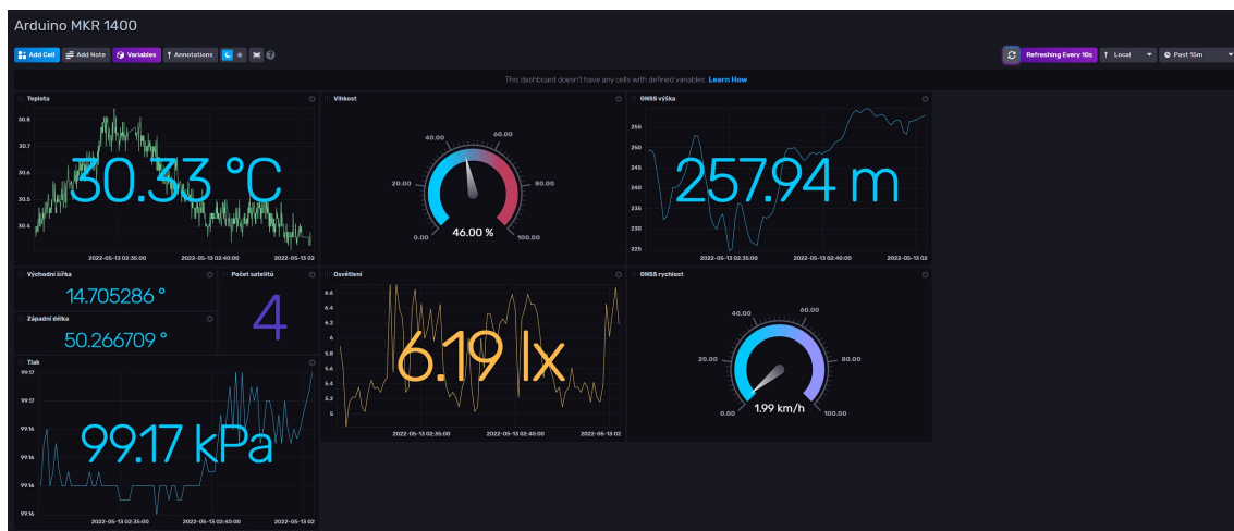
Obrázek 4.9. Dashboard s ukázkou zobrazení dat v reálném čase, přijímány jsou data o teplotě, tlaku, osvětlení, vlhkosti a dále pak data s GPS shieldu o poloze, rychlosti, výšce a počtu satelitů.
